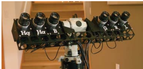
FLIカメラで連装した、LRGB+Hα 同時撮影システム
